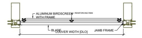
1) TYPICAL LOUVER PLAN AND ELEVATION
